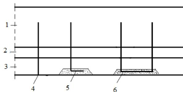
1 – внутренний каменный слой, 2 – слой теплоизоляции, 3 – облицовочный каменный слой,
