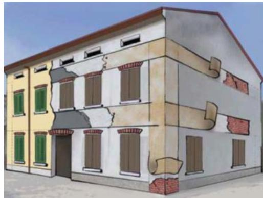
**Рисунок 11.8.** Поверхностное армирование сетками из композитных материалов угловых зон и междуоконных поясов
